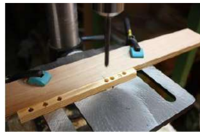
Centrage du perçage et réglage de la profondeur
