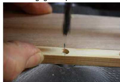
Centrage du perçage et réglage de la profondeur
