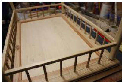
Percement de l'emplacement des barreaux dans le plateau puis vérification.
